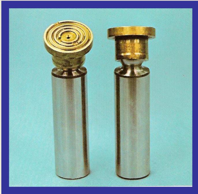
A sapata é fixada ao pistão e funciona como uma bola e suporte conservando um contato rente com a placa de torque ou do disco de esguicho. A sapata deve girar livremente no pistão e dobra-se em todos os ângulos, até 360°.
