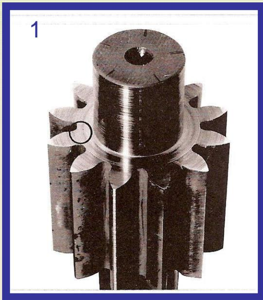
1- desgaste do colo da engrenagem devido à contaminação por cavacos.
