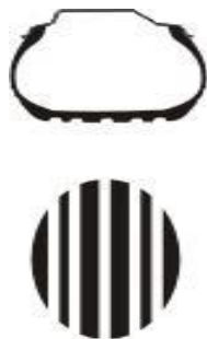
PNEU DIAGONAL SEM CARGA E ÁREA DE CONTATO COM O PISO
