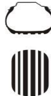
PNEU RADIAL SEM CARGA E ÁREA DE CONTATO COM O PISO
