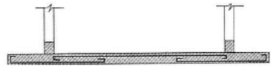
Figura 5.11 - Disposição da armadura no radier
