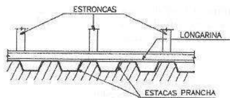
Figura 3.10 - Cortina de estacas-prancha metálicas
