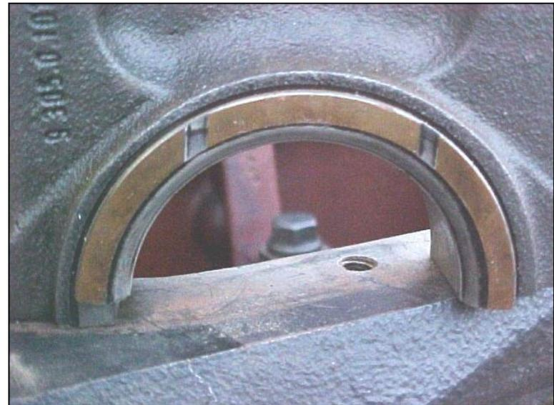
*Desgaste causado por sobrecarga axial*
