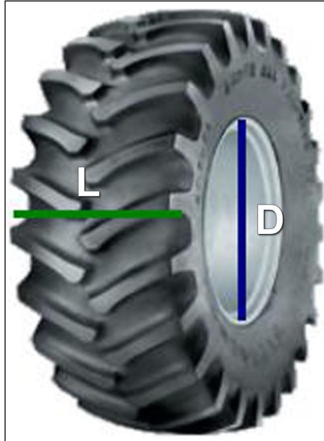
É designada por dois conjuntos de números, o primeiro indica em polegadas o valor nominal da largura (L) da secção e o segundo o diâmetro nominal interno (D) do pneu, em polegadas:
